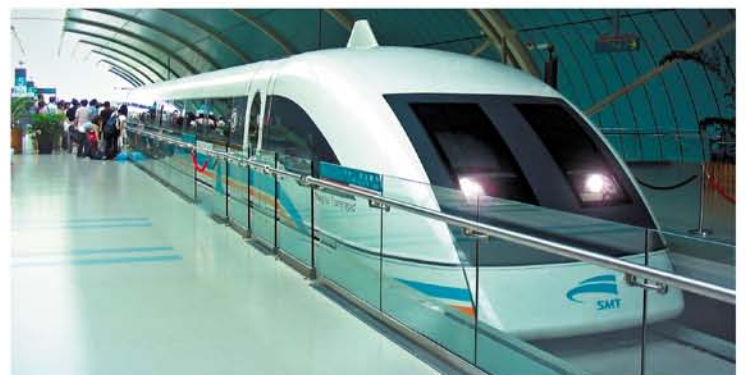
Maglev, en Chine Le Maglev, pour Magnetic Levitation, est un train qui utilise des forces magnétiques pour se déplacer. Il n'est donc pas en contact avec les rails lorsqu'il avance. Il a atteint des vitesses dépassant les 500 km/h.
